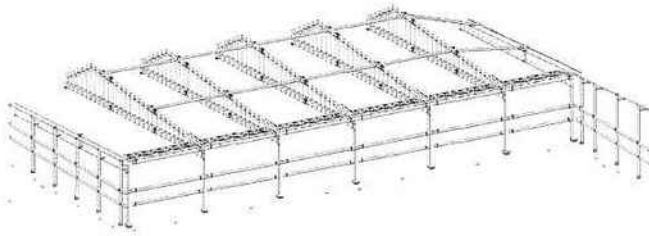
▲ Axonométrie de la structure primaire en métal. Des pannes métalliques jouent un rôle de maintien provisoire entre les portiques aux poutres échelles.
