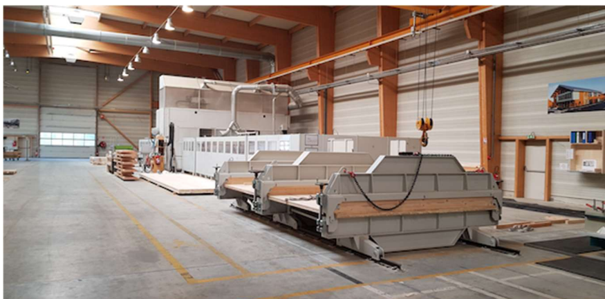
Presse de collage pour planchers nervurés (PNM)
